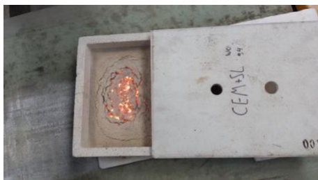
Figuur 10 gedehydrateerd cement in een bakje dat net door de microgolfoven gegaan is. Binnenin is de temperatuur opgelopen tot boven 700°C (gloeiende massa).
