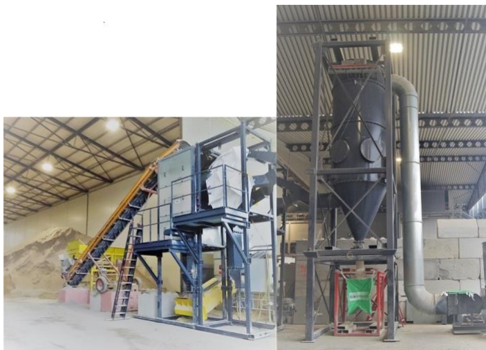
Figuur 3 Smart Refiner. Links, aanvoer van de fractie < 4 mm via een transportband en 1 ste scheidingsstap. Rechts: afscheiding van fijnste fractie
