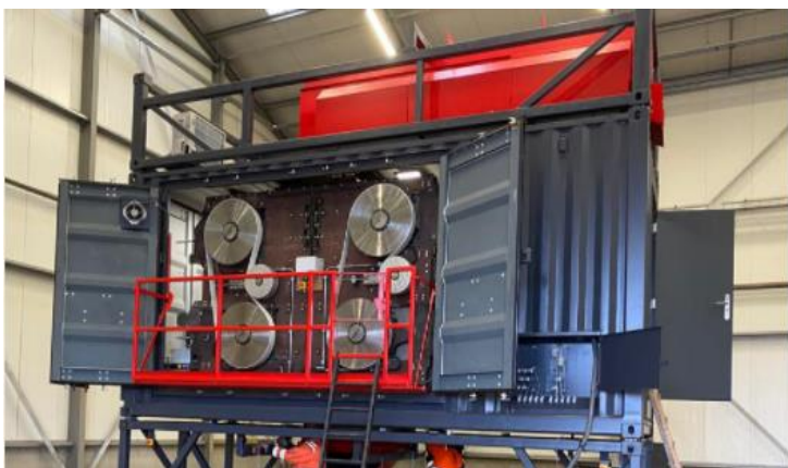
Figuur 2 Zij aanzicht van de aandrijving van de SmartCrusher.
