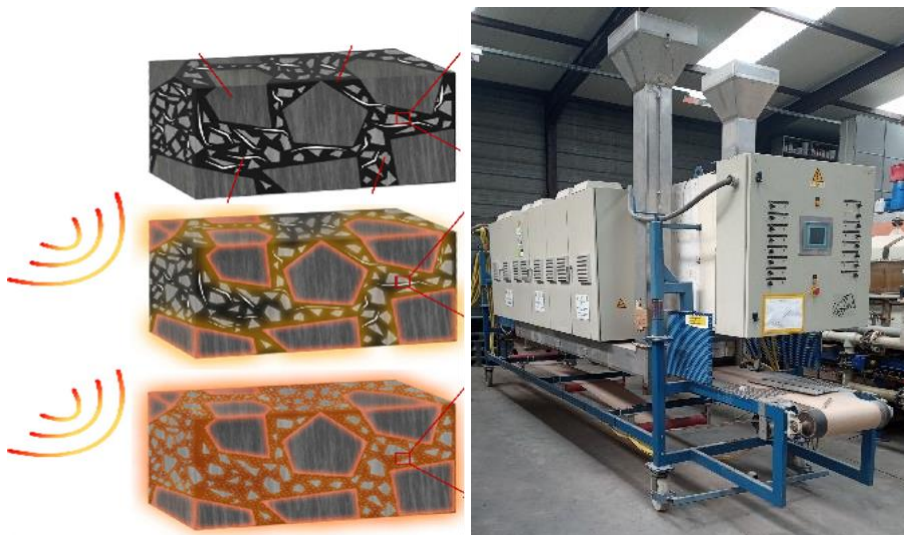
Figuur 1 Links Effect van microgolven op het breken van beton. Zhao et al. © 2017 American Society of Civil Engineers Rechts microgolfoven met transportband waarop de betonbrokstukken gedeponeerd worden.
