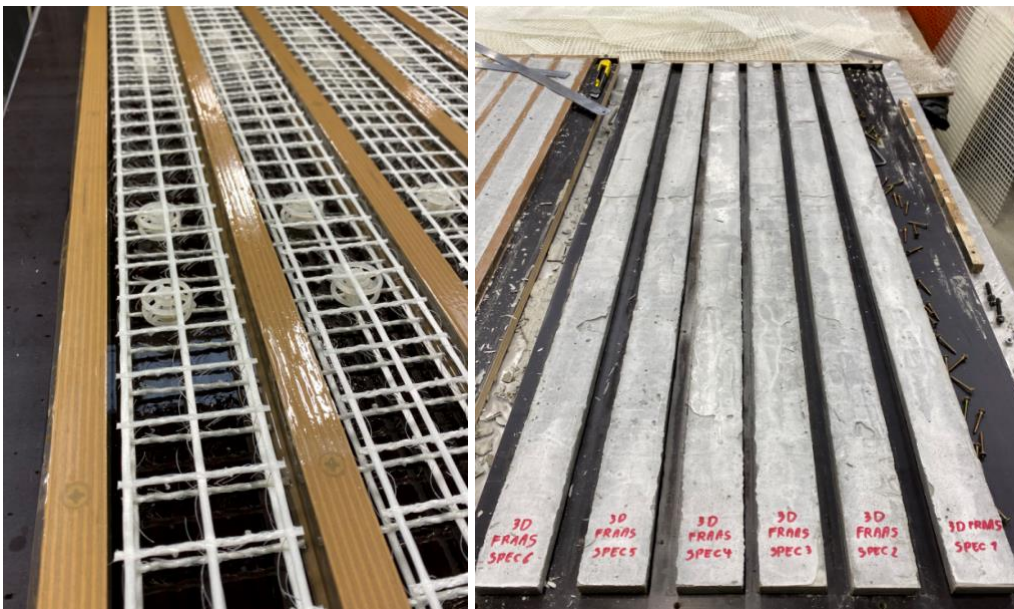
Figuur 14 Links verankering van 2 textiellagen Rechts proefstukken met textielwapening voor mechanische testen.
