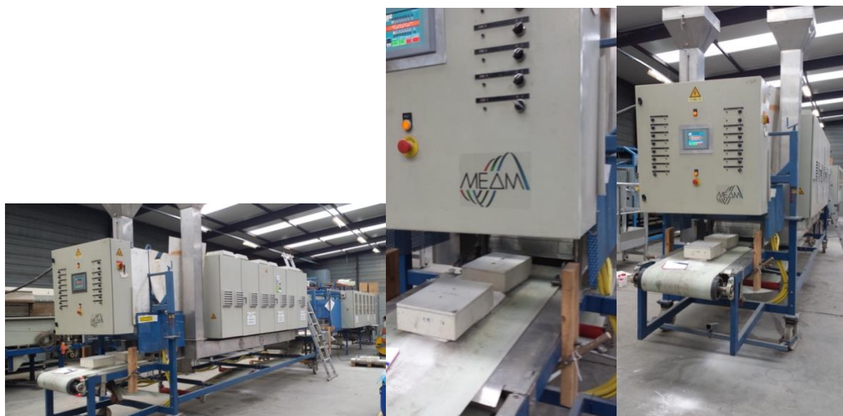
Figuur 9 Microgolfoven met alumina containers om gehydrateerd cement te verhitten tot boven 500°C.
